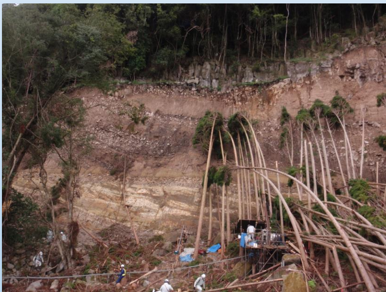
滑落崖に見える溶結凝灰岩と水中堆積物
